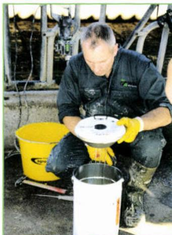
**5. Verbinden der beiden Komponenten:** Aufgrund des Deckel-Durchschlagens fließt die erste Komponente in den unteren Behälter, in dem sich die zweite Komponente befindet. Die zwei Komponenten der Harzverbindung kommen nun miteinander in Berührung. Ab jetzt läuft der „Countdown“ zur Härtung.
