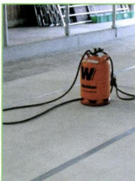
**2. Abflammen:** Mit einem solchen Gasbrenner können durch Abflammen der Fläche hartnäckige Fett-Eiweiß-Verbindungen aus den Fugen gelöst werden. Die Fläche trocknet dadurch zudem schnell für die weitere Bearbeitung ab. Asche- und Staub-Rückstände werden anschließend mit einer Luftpistole entfernt.
